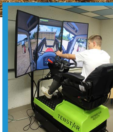
Utilisation d'un simulateur de conduite d'engins agricoles dans le cadre des séances pratiques en agroéquipement.
